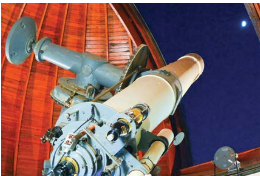
Vizuální refraktorový teleskop Zeiss ve Vatikánské observatoři v Castel Gandolfo. Foto: H. Aziz KAYIHAN / wikimedia
